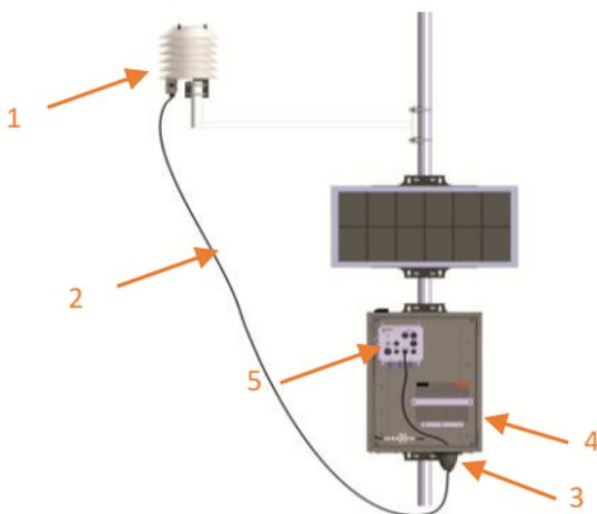
1 – Измеритель Сокол – ТДВ; 2 - Кабель снижения М23 ТЕМГ.685631.003 – 02; 3 – Муфта; 4 - Блок вычислительный; 5 – Блок коммутации ТЕМГ.467239.004.
