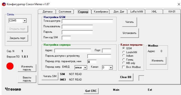
Рисунок 10 - Вкладка «Сервер» (поле ModBus)
