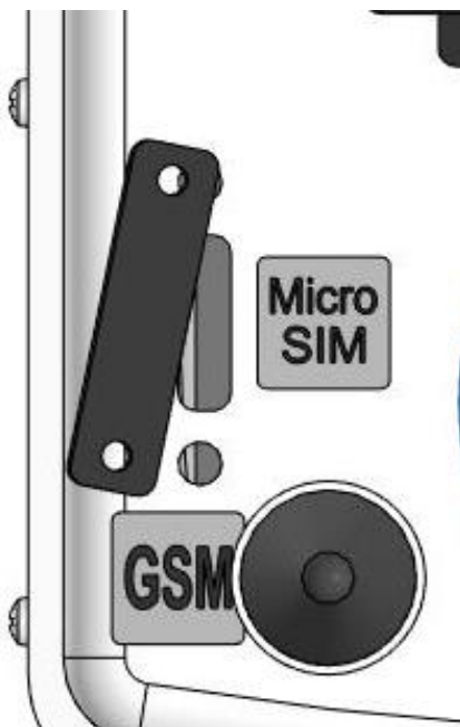
Рисунок 17 – Место установки SIM-карты
