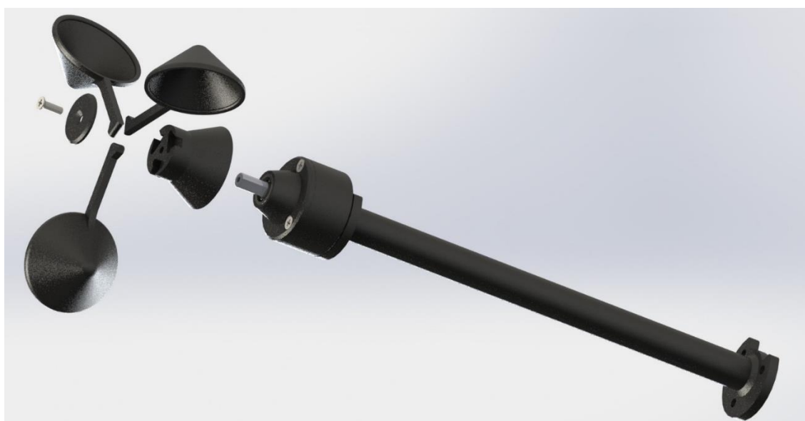
Рисунок 20 – Сборка чашечного анемометра
